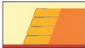
شیب خاک مسلح با نمای برگشتی سبز (۷۰-۸۰ درصد) • مقاوم در برابر اثرات محیطی • نصب سریع • امکان اصلاح هندسی شیب
